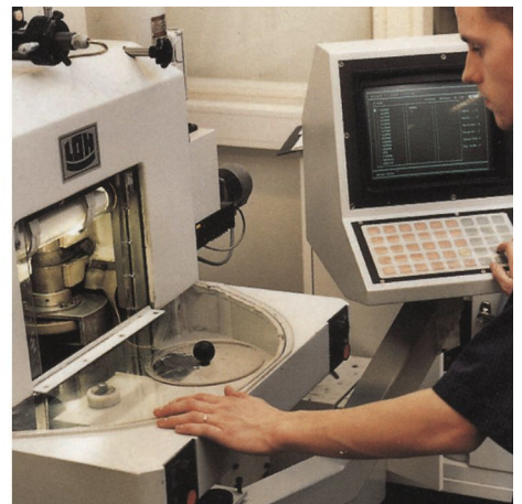
Abbildung 14.4 LINKS: Diamantdrehmaschine RECHTS: Schleifen eines Objektivs
