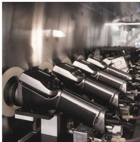
Abbildung 14.5 LINKS: Testen von Infrarotkameras in der Klimakammer; RECHTS: Roboter zum Testen und Kalibrieren von Kameras
